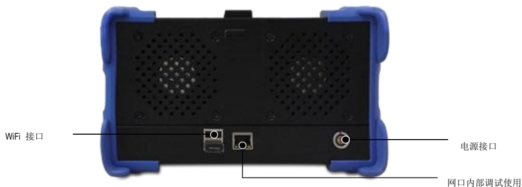
发射机背面连接示意图
